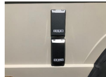
● I H用電源引き込み口 (100V 1500w)
