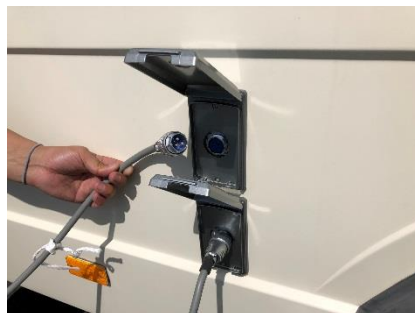
● 外部電源引き込み口 (100V 1500w)
