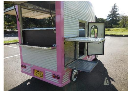
ベース車両：スズキキャリイ 走行移動時外寸 長さ 3390 幅 1470 高さ 2600（車内高1780）
