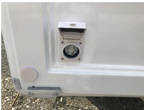
●外部電源引き込み口
