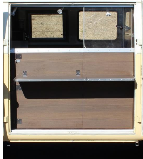
● 販売面カウンター及び引き違い窓
