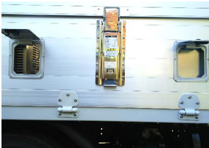
●ケーブル引き込み口
