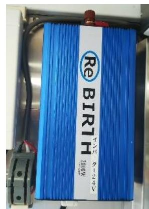
●インバーター(2.0kw) ※車両バッテリー使用
